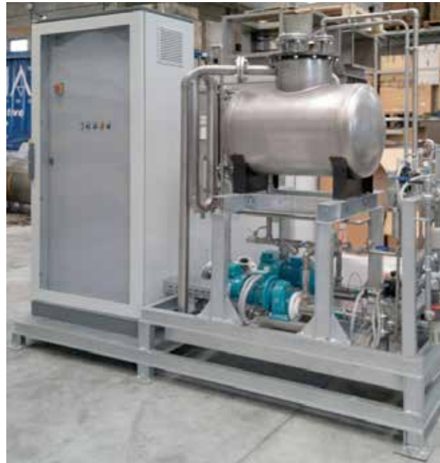
FIGURA 2 - Skid completo di pompe, riserva NH 4 OH e quadro elettrico di gestione per il dosaggio del reagente necessario per la riduzione selettiva degli NO x , apparecchiatura utilizzata per i sistemi SNCR installati su caldaie alimentate a biomassa solida e reattori SCR per motogeneratori alimentati a biomassa liquida
